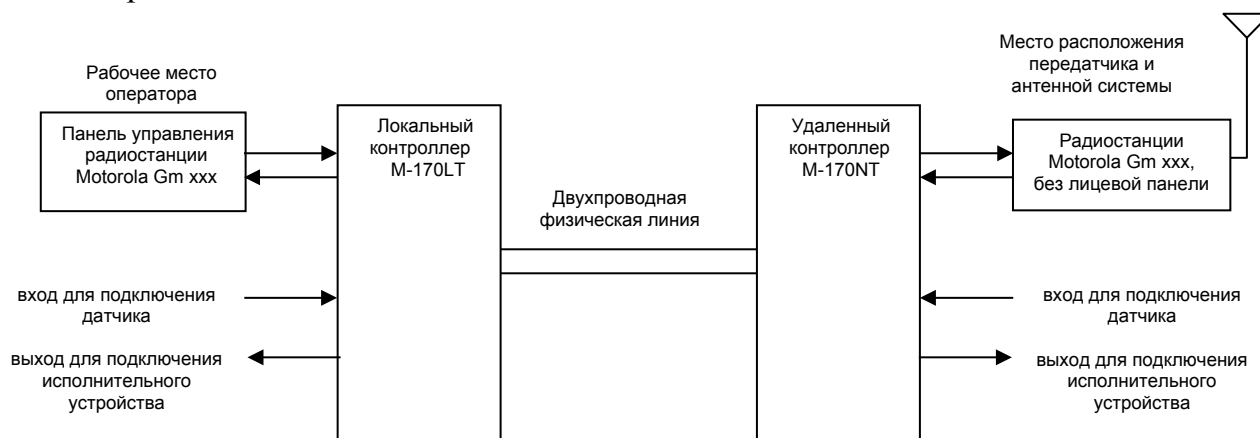
Рис.1. Организация дистанционного управления радиостанциями MOTOROLA серии GM.
