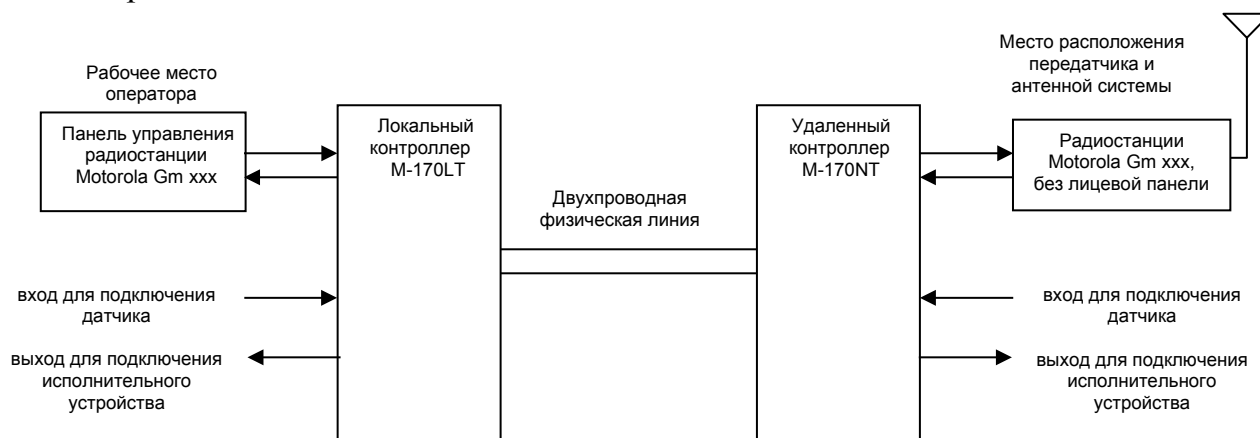
Рис.1. Организация дистанционного управления радиостанциями MOTOROLA серии GM.
