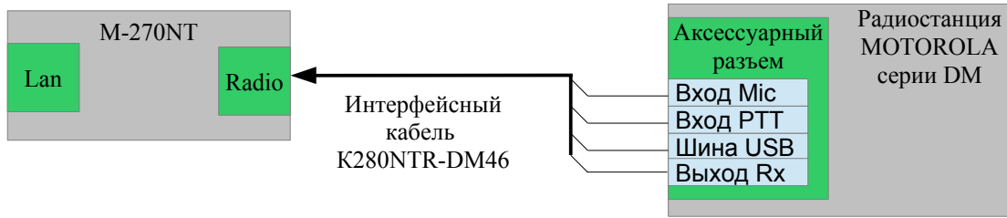
Рис. 13 Схема подключения радиостанций к контроллеру M-270NT, при работе интерфейса в режиме «MOTOROLA DM».
