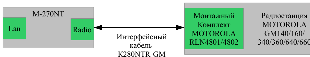
Рис. 12 Схема подключения радиостанций к контроллеру М-270NT, при работе интерфейса в режиме «MOTOROLA GM».
