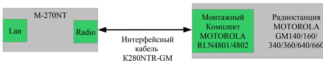
Рис. 12 Схема подключения радиостанций к контроллеру М-270NT, при работе интерфейса в режиме «MOTOROLA GM».
